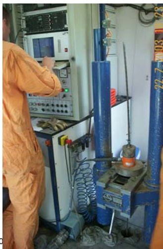
▲ principe van uitvoering van Pull-Out-Resistance-Test vanuit eestandaard sondeertruck
